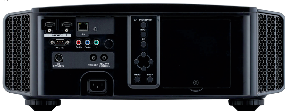
机身背面集合了各种视频输入端子与控制端子，当中包括两组HDMI与一组分量视频端子
