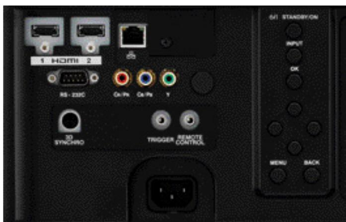
Il pannello delle prese di collegamento è lo stesso per i due modelli JVC: 2xHDMI 3D con Deep Color e CEC, Lan Ethernet, RS-232C, Component, 3D Sync, Trigger e comando a distanza. A fianco, sulla destra, sono disponibile comandi locali per navigare fra i menu dell'OSD e gestire le funzioni necessarie
