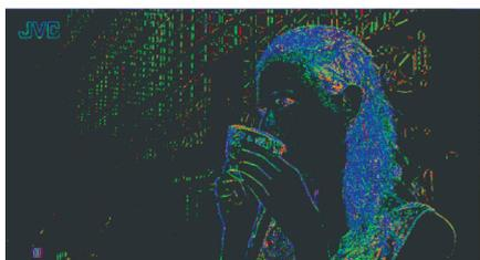
再次按下MPC按键，则会显示分析模式，画面会变成油画般的影像，着色的部分表示已经经过MPC处理
