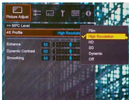
按下MPC按键后，将会进入MPC Level的菜单，打开4K Profile的菜单会找到Flim、High Resolution、HD、SD、Dynamic以及off等数个选项
