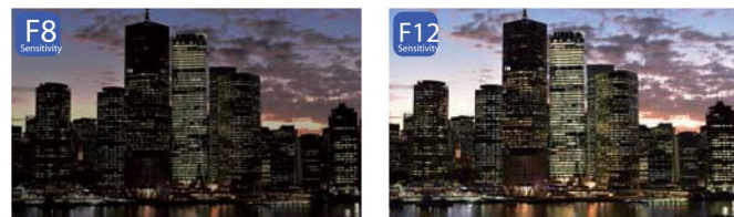
比较传统摄像机 F8 灵敏度 (左) 与 GY-HM660 在 2000 lux 时达到 F12 (60Hz) 灵敏度之间的图像亮度。
