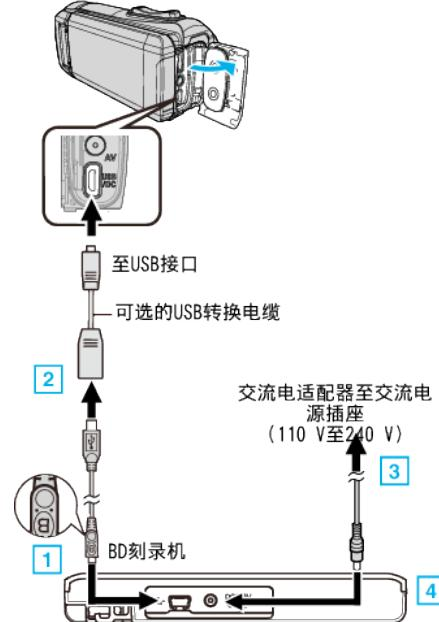
连接 BD 刻录机(外置蓝光驱动器)的 USB 电缆。
