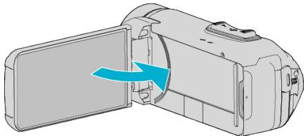
POWER/ACCESS 指示灯熄灭,电源关闭。
