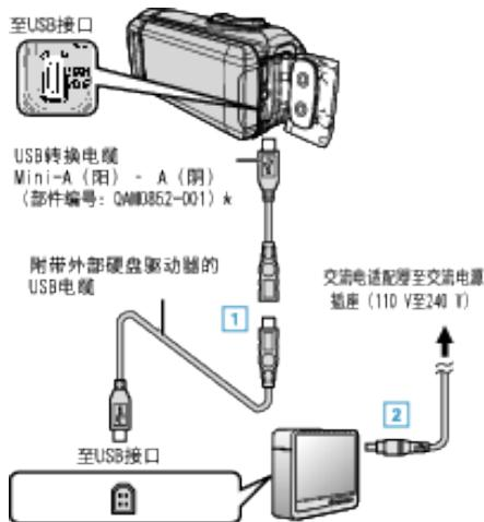
① 将 USB 电缆与 USB 外部硬盘驱动器连接。
