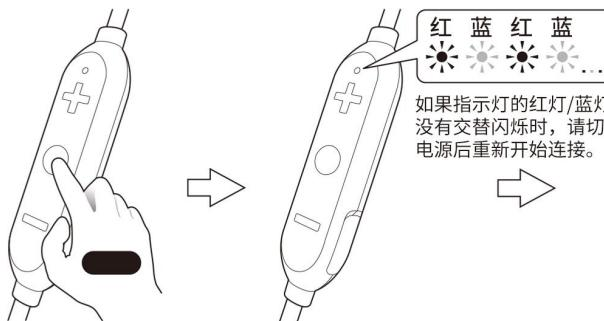
如果指示灯的红灯/蓝灯没有交替闪烁时，请切断电源后重新开始连接。
