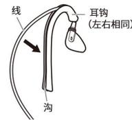
如图所示将耳机部分和耳钩部分的方向对齐，将线将直后将线填入耳钩的槽中。
