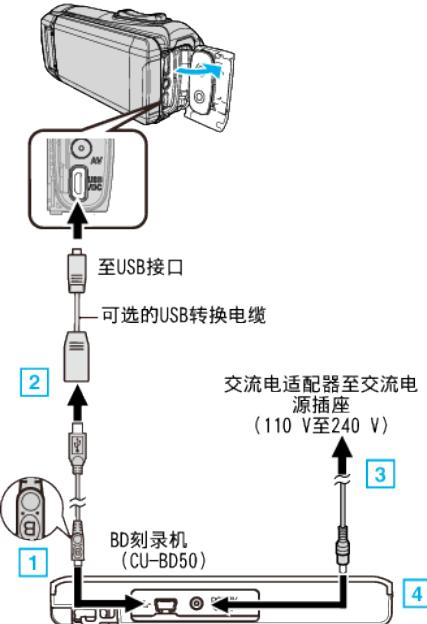
连接 BD 刻录机(外置蓝光驱动器)的 USB 电缆。
