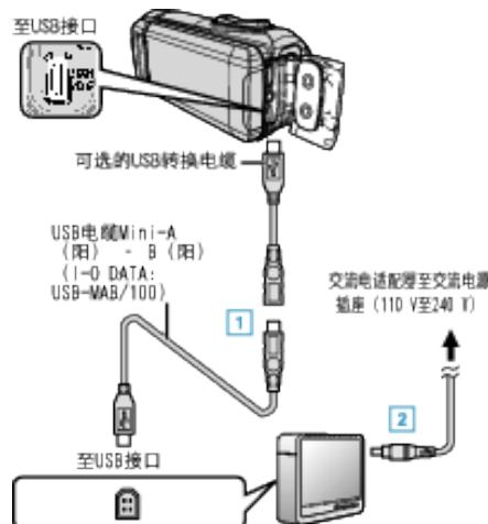
① 将 USB 电缆与 USB 外部硬盘驱动器连接。
